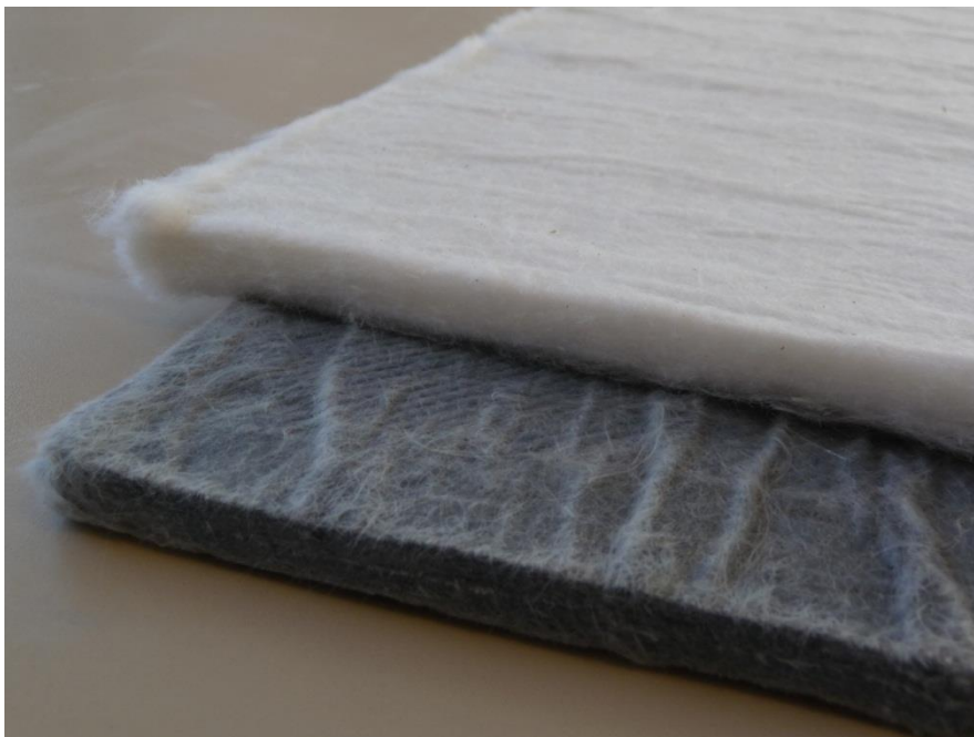
Abbildung 45: Aerogel Pulver in Polyestervlies-Hüllen als Wärmedämmstoff für Gebäude
