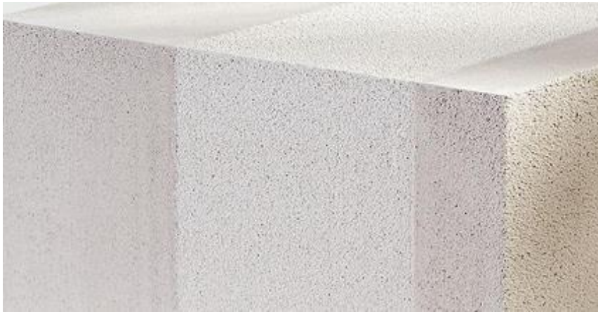
Abbildung 41: Innovationssprung Porenbeton durch Kombination von zwei Schichten Porenbeton mit einem Kern aus hochwärmedämmendem Porenbeton [Quelle: Xella 2013]
