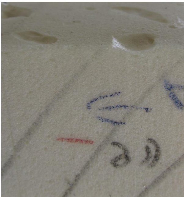
Abbildung 36: Untersuchung der Zellform und der Ausdehnung der Zellen eines PU-Schaums zur Optimierung der Wärmeleitfähigkeit. Der blaue Pfeil zeigt die Band-Vorschubrichtung bei der Herstellung. Der Schaum steigt bei der Herstellung von unten nach oben. Bild: FIW München
