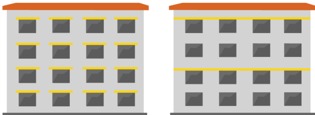
Abbildung 98: Sturzschutz (links) und Brandschutzriegel (rechts) zur Verhinderung der Brandweiterleitung über die Fassade (Quelle: [WID 2013])
