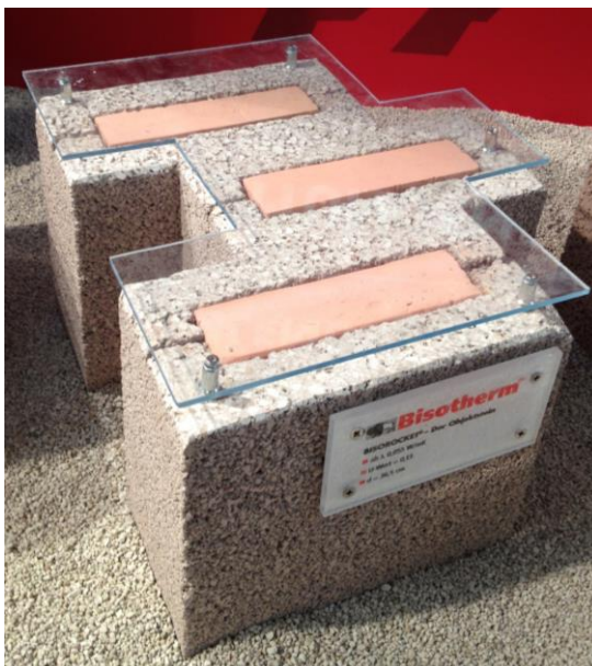
Abbildung 43: Haufwerksporiger Leichtbeton mit Füllung aus Phenolharz-Hartschaum. Bemessungswert der Wärmeleitfähigkeit 0,070 bis 0,055 \text{ W}/(\text{m}\cdot\text{K}) – dargestellt ist der sog. Objektstein mit einem Bemessungswert der Wärmeleitfähigkeit von 0,065 \text{ W}/(\text{m}\cdot\text{K}) .
