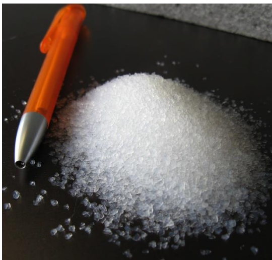
Abbildung 1: Aerogele (hier transluzent) werden als Schüttungen in Hohlräumen von Gebäuden eingesetzt oder verbessern die wärmetechnischen Eigenschaften von herkömmlichen Dämmstoffen, wie z. B. Mineralwolle
