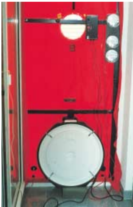
Bild 26: Einbau des Blower-Door- Ventilators und der Messeinrichtung
