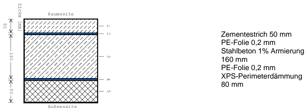
Abbildung 8 Schematische Darstellung des Fußbodenaufbaus der Bodenplatte Lagerhalle (ZUB Systems GmbH 2019)
